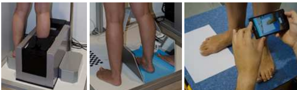
Figura 25. Adquisición digital 3D de pies, de izquierda a derecha: escáner de alta resolución, DomeScan, aplicación de captura.
