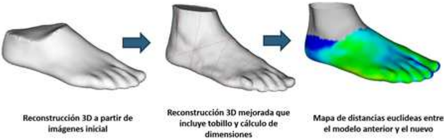
Figura 15. Mejoras desarrolladas en el método de reconstrucción 3D de pies.
